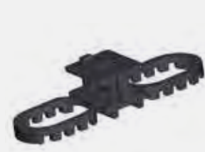
Kebony Terrassenclip RASK Kunststoff, V2A Befestigungsplatte ca. 20 Stk./m 2 (c/c 50 cm), 125 Stk. mit Schrauben
